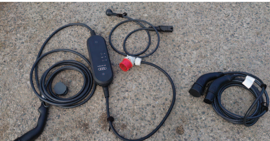
■ Audi e-tron má nadštandardnú výbavu nabíjacích káblov, vľavo univerzálny kábel Typ 2 s vymeniteľnou koncovkou na 3 × 400 V a 1 × 230 V (Schuko), vpravo kábel Typ 2-Typ 2.
